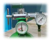
Para sua utilização deve possuir registro (abre e fecha o oxigênio), um regulador (existem diferente tipos no mercado) que reduz a pressão do cilindro a pressões seguras para uso permitindo regular a quantidade de O2 a ser administrado (1 a 25 litros/min).
