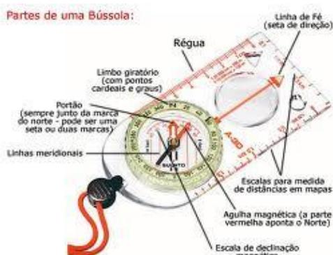
Para orientar-se com uma bússola de limbo móvel, aponta-se a sua seta de navegação (indicador do azimute) para o ponto desejado; gira-se o limbo até que a seta da graduação (identificada com N) coincida com a ponta vermelha da agulha; a numeração do limbo que coincidir com a seta de navegação é o azimute magnético do ponto em que se está até o designado como objetivo.
